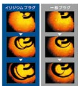
※写真は燃焼状態を高速度カメラにて撮影したものです
